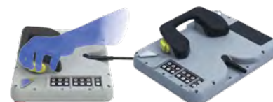
Le TP ERP400S en option intègre une touche d'activation à 3 modes pour une sécurité renforcée.
